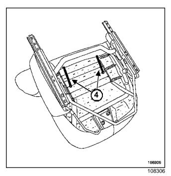
Снимите эластичные фиксаторы 4.
