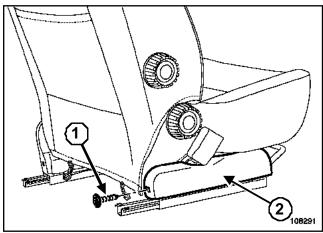
Отверните болт 1. Снимите кожух 2
