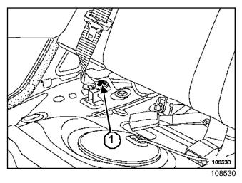
Отверните болты **1** крепления ремней безопасности.
