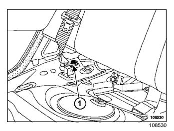
Отверните болты **1** крепления ремней безопасности.
