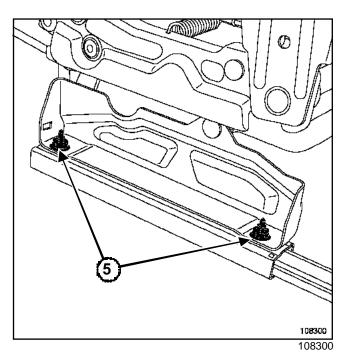
Отверните с каждой стороны гайки 5 крепления салазок сиденья.
