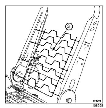
Снимите комплект пружин 3.
