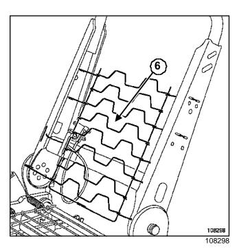
Снимите комплект пружин 6.
