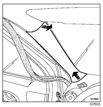
Снимите облицовки стоек проема ветрового стекла.
