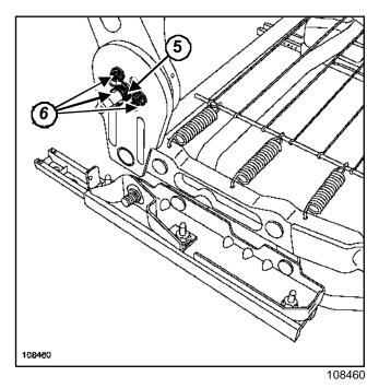
Снимите пружину 5.
