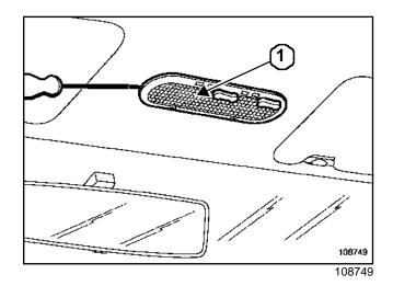
Отверткой с плоским лезвием отожмите защелки стекла 1 плафона освещения салона.
