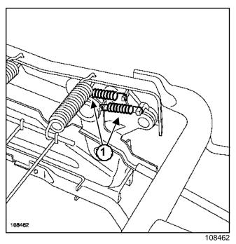
Снимите оттяжные пружины 1, используя плоскую отвертку.
