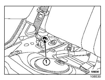
Отверните болты **1** крепления ремней безопасности.
