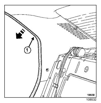
Снимите частично уплотнитель.1
