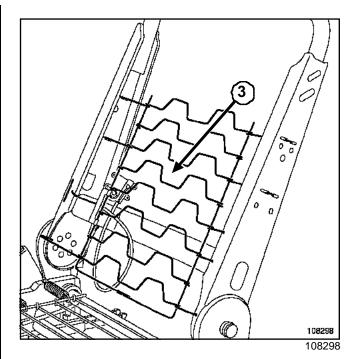
Снимите комплект пружин 3.
