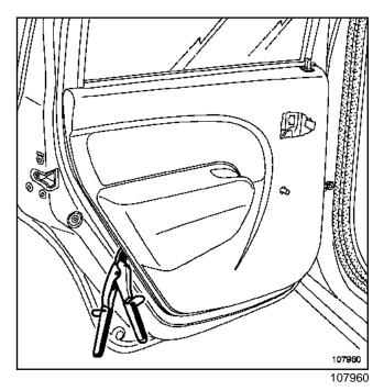
Снимите обивку двери при помощи щипцов для снятия держателей обивок и облицовок.
