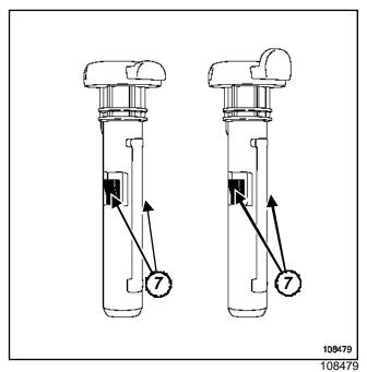
Нажмите на фиксаторы 7 отверткой с плоским лезвием.
