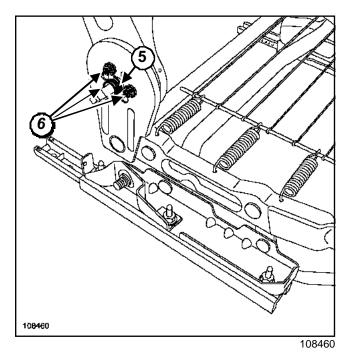
Снимите пружину 5.
