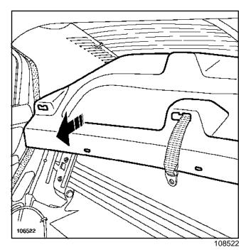
Снимите обивку задней полки.
