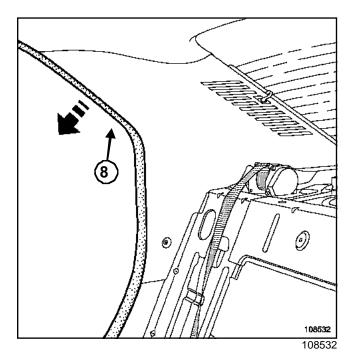
Снимите частично уплотнитель.8
