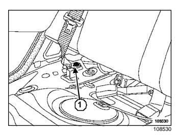
Отверните болты **1** крепления ремней безопасности.
