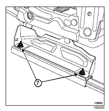
Отверните с каждой стороны гайки 7 крепления салазок сиденья.
