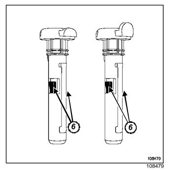
Нажмите на фиксаторы 6 отверткой с плоским лезвием.
