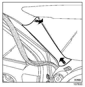
Снимите облицовку стойки проема ветрового стекла.
